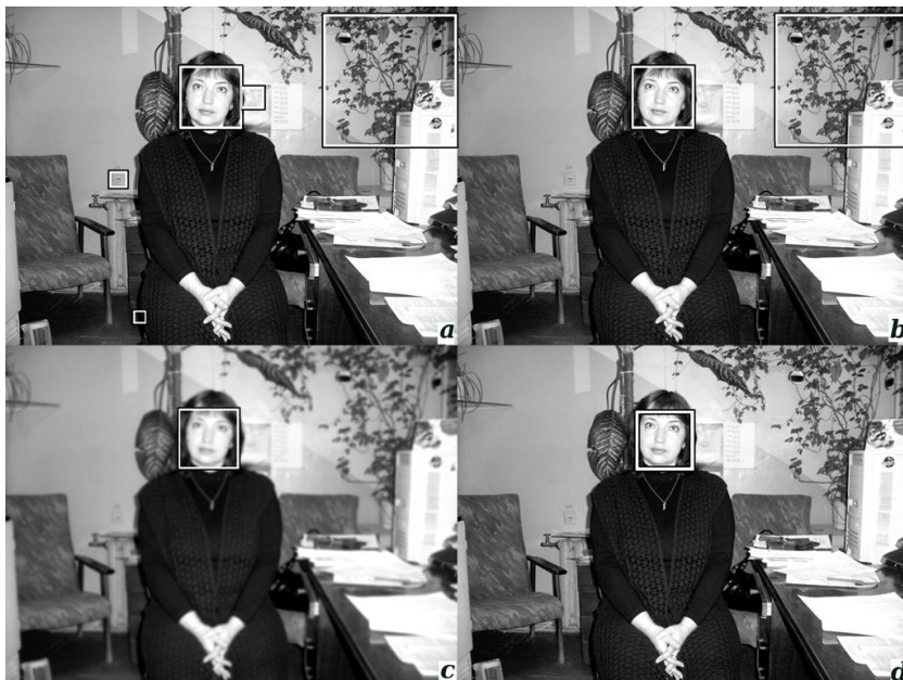
Рис. 2. Пример работы алгоритма поиска лиц (Viola-Jones, реализация: OpenCV 2.1) с различными параметрами на предобработанных изображениях размера 3264x2448 пикселей: a – исходное изображение, настройки по умолчанию; b – минимальный размер искомого лица (параметр алгоритма) установлен равным 240; c - размытое изображение (СКО=8), настройки алгоритма поиска по умолчанию; d - размер изображения уменьшен в 4 раза, параметры по умолчанию
