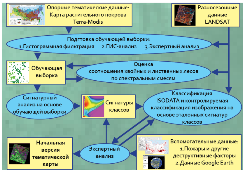
Рисунок 6 – Блок-схема тематической обработки временных серий спутниковых изображений
