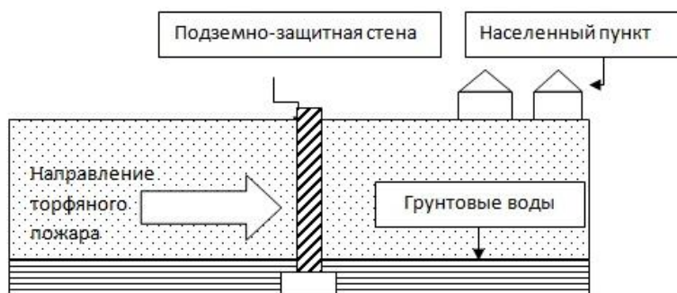
Рис.2. Подземно-защитная стена (вид сбоку)
