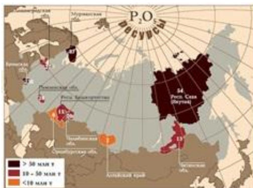
Рис. 2. Распределение прогнозных ресурсов фосфатных руд категорий P1, P2 и P3, приведенных к условной категории P1, по субъектам РФ, в млн. тонн P2O5, на 1.01.2007 г. [1].
