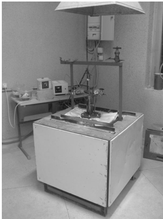
Рис.4 - Общий вид лабораторной установки для исследования высокотемпературного пиролиза импрегнированных образцов обожженных анодов в жидкометаллическом теплоносителе свинец-висмут
