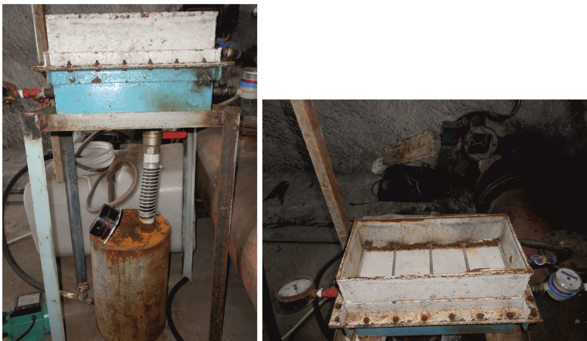
Рис. 2. Полупромышленная установка доочистки сточных вод.
