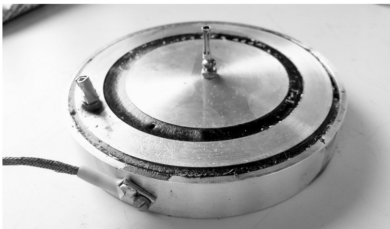
Рисунок 3.1 образец для измерений, помещенный между измерительных электродов
