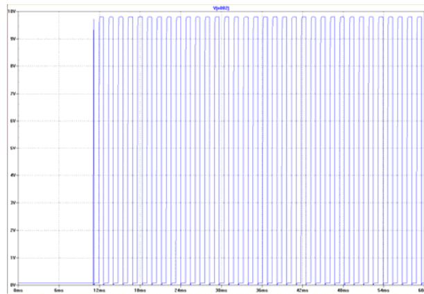
Рисунок 2.3 Выходной сигнал мультивибратора. Расчет с помощью программы анализа электронных схем LTspice IV
