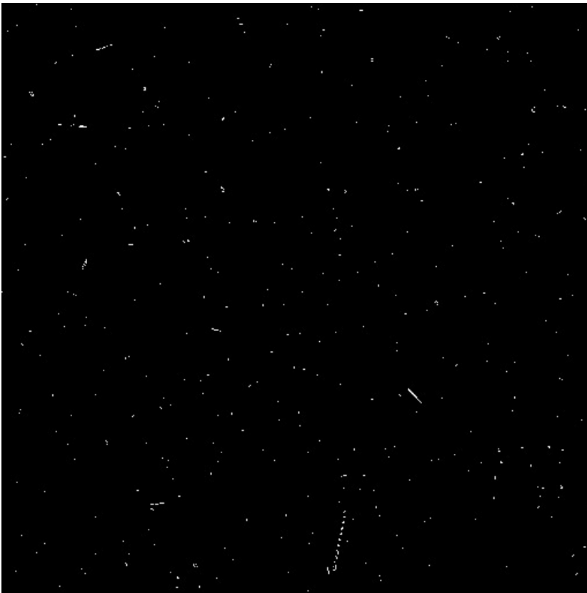
Рисунок 1.6 Кадр, зарегистрированный после солнечной вспышки 14 июля 2000 г. прибором БОКЗ, установленным на геостационарном спутнике «Ямал-100»
