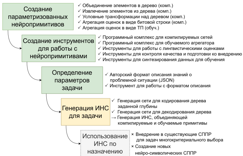
Рис. 6 — Процесс создания нейросимволических модулей для ИСППР. Зелёным отмечены блоки, укомплектованные готовыми моделями, алгоритмами и программными комплексами, жёлтым - блок, требующий доработки готовых решений, серым - блок, требующий дальнейших исследований. Справа от каждого блока указаны полученные результаты, либо шаги, требующие доработки.
