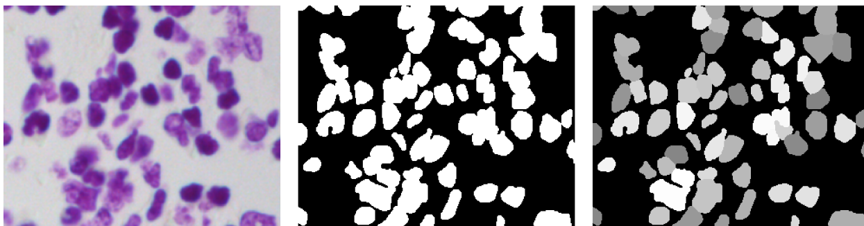
Рис. 1: Примеры сегментирования слева направо: исходное изображение, семантическое сегментирование, сегментирование отдельных объектов. Источник изображения и аннотации сегментирования: набор данных Data Science Bowl 2018 [11].
