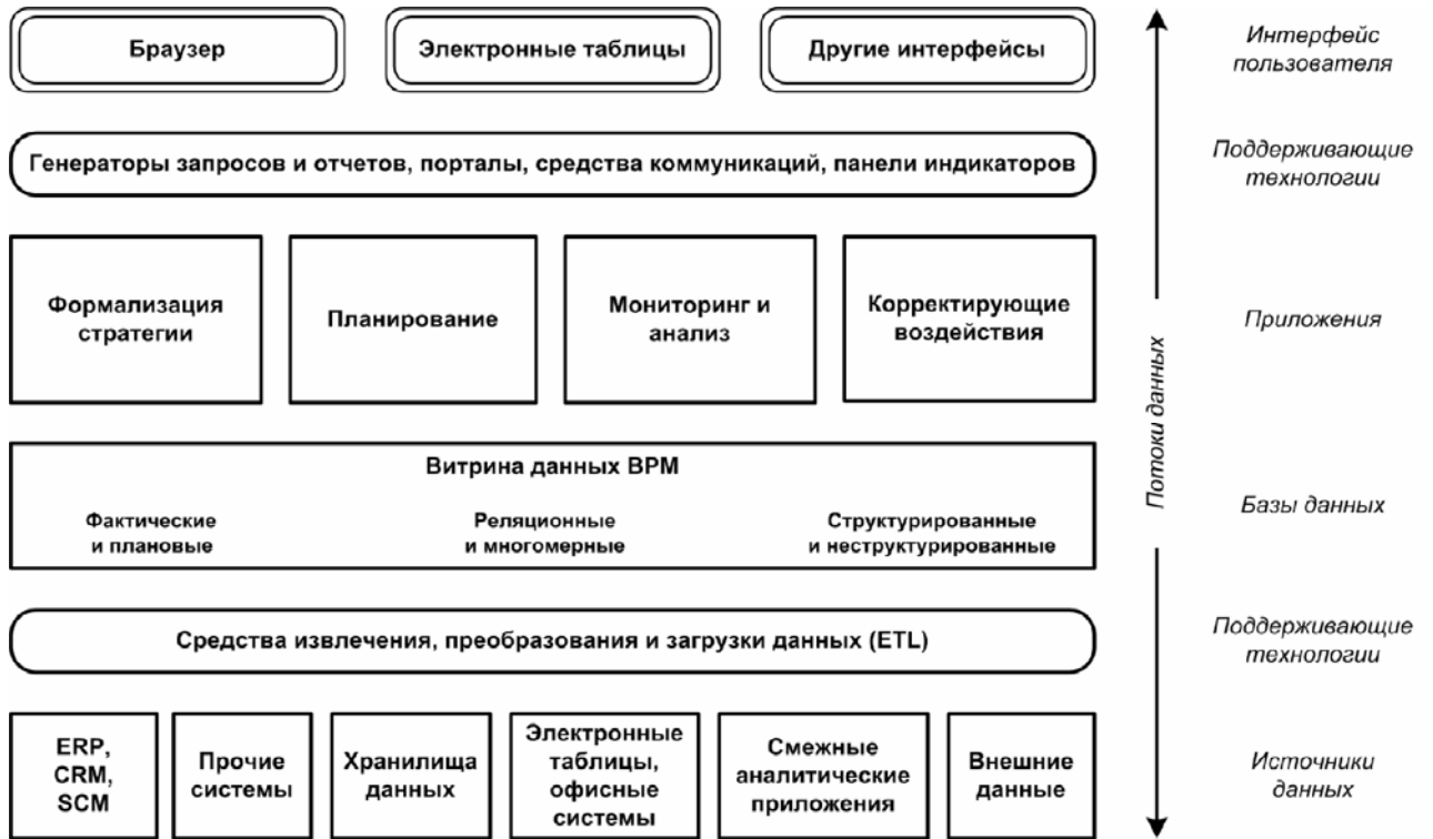
Рис. 4.1. Технологическая архитектура BPM-системы
