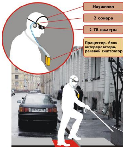
Рис. 38. Принцип работы первой версии устройства технического зрения (проект Oriense)
