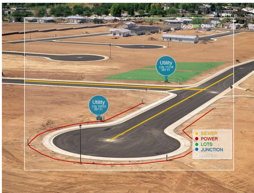
Рис. 59. Система дополненной реальности в строительстве (прокладывании подземных линий коммуникаций)
