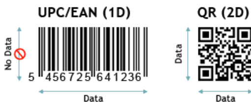
Рис. 54. Сравнение линейного и двухмерного штрих-кодирования (на примере QR-кода) [105]
