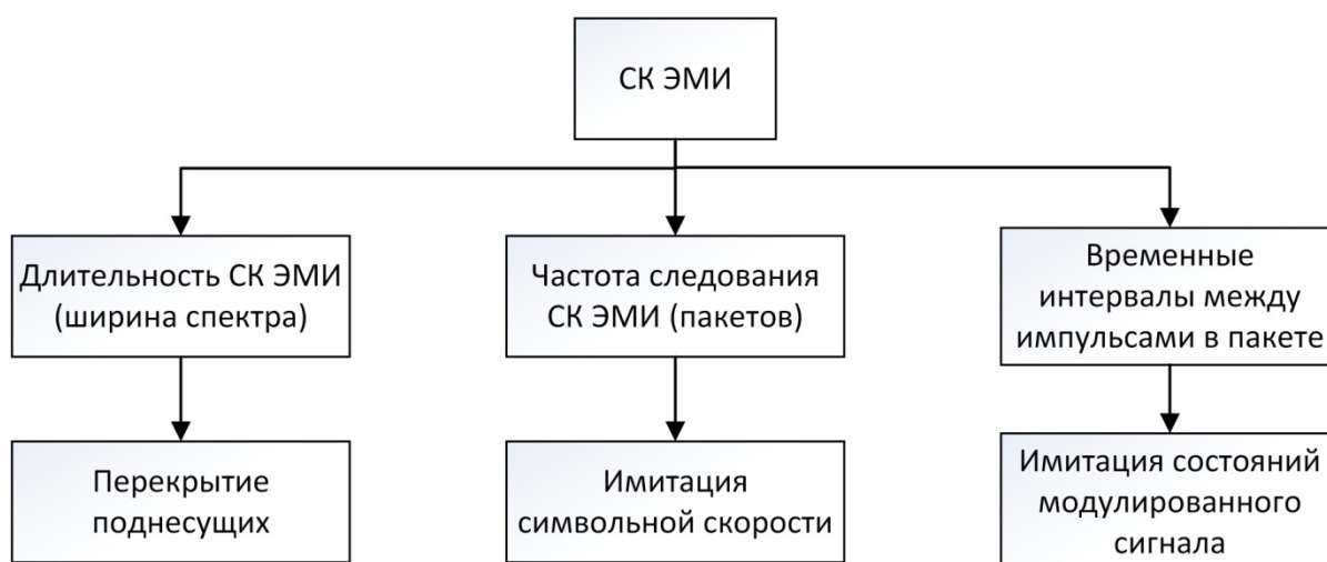
Рис.2.8 Схема влияния последовательности влияния сверхкоротких электромагнитных импульсов на прием и демодуляцию поднесущей частоты.
