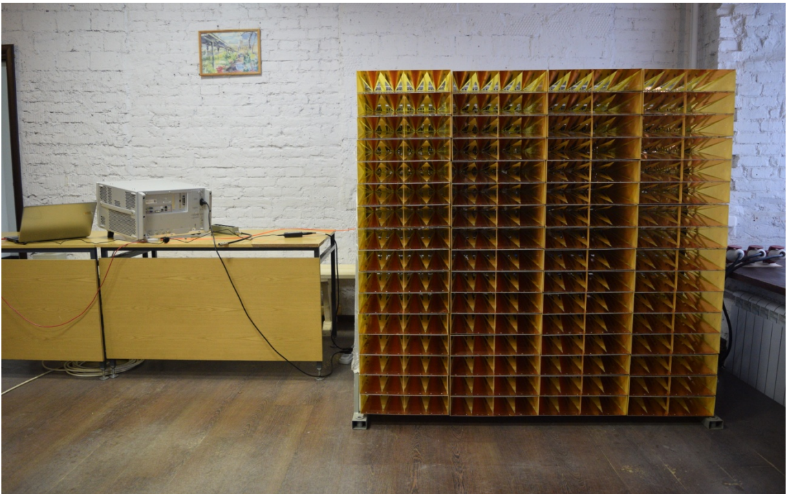
Рис. 3.3. Сборка из 64 антенных модулей.
