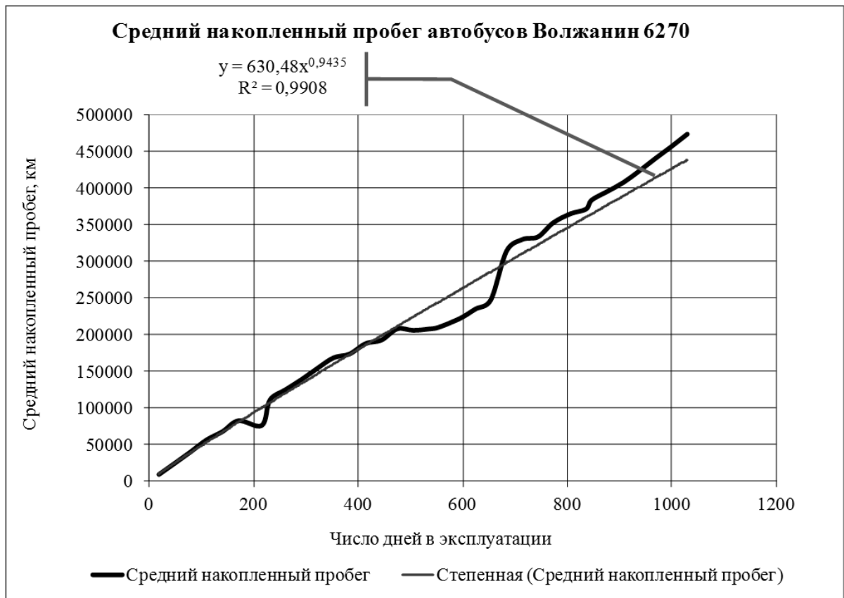
Рисунок 3.7 – Динамика изменения значений среднего накопленного пробега при увеличении числа дней в эксплуатации для автобусов Волжанин-6270
