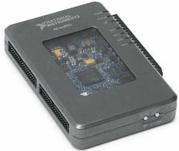
Fig. 4. Universal programmable controller NI MyRIO
