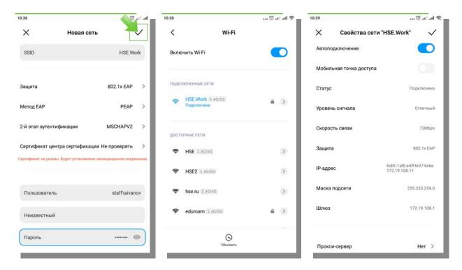
После заполнения указанных выше параметров подключения необходимо сохранить настройки, нажав на кнопку «Сохранить». В списке доступных для подключения сетей Wi-Fi появится строка с именем «HSE.Work». Устройству при подключении будет присвоен IP адрес, который можно обнаружить в свойствах сети.
