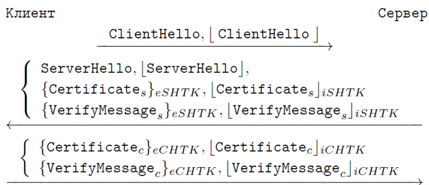
Рис. 4. Схема аутентификации на основе ключа проверки электронной подписи. Транспортный уровень (Fig. 4. Authentication scheme based on digital signature. Transport layer)
