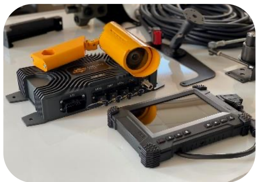
Система автономного управления для комбайна CognitiveAgro Pilot
