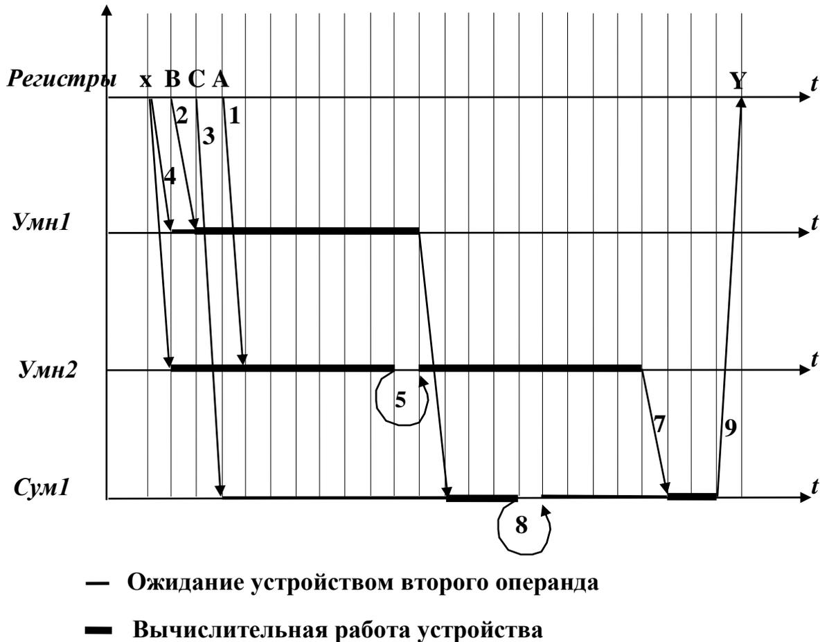
В данной системе время пересылки – 1 такт, поэтому-то линии, обозначающие передачу, здесь наклонные, что иллюстрирует задержку
