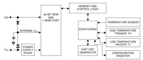
Figure 19. Internal DS18B20 components.
