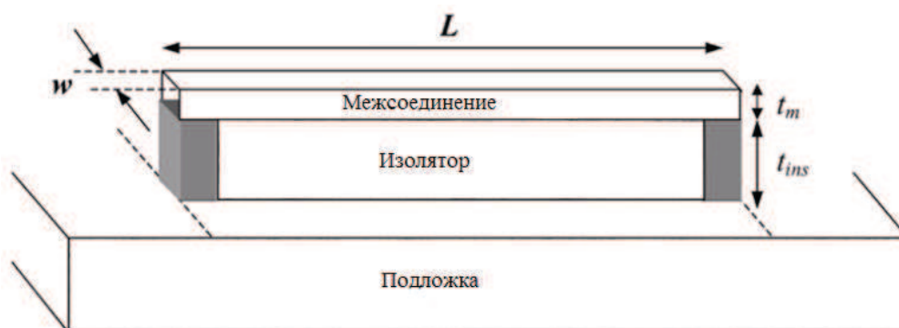
Рис. 1. Линия межсоединения, проходящая по подложке, отделенная слоем изоляции
